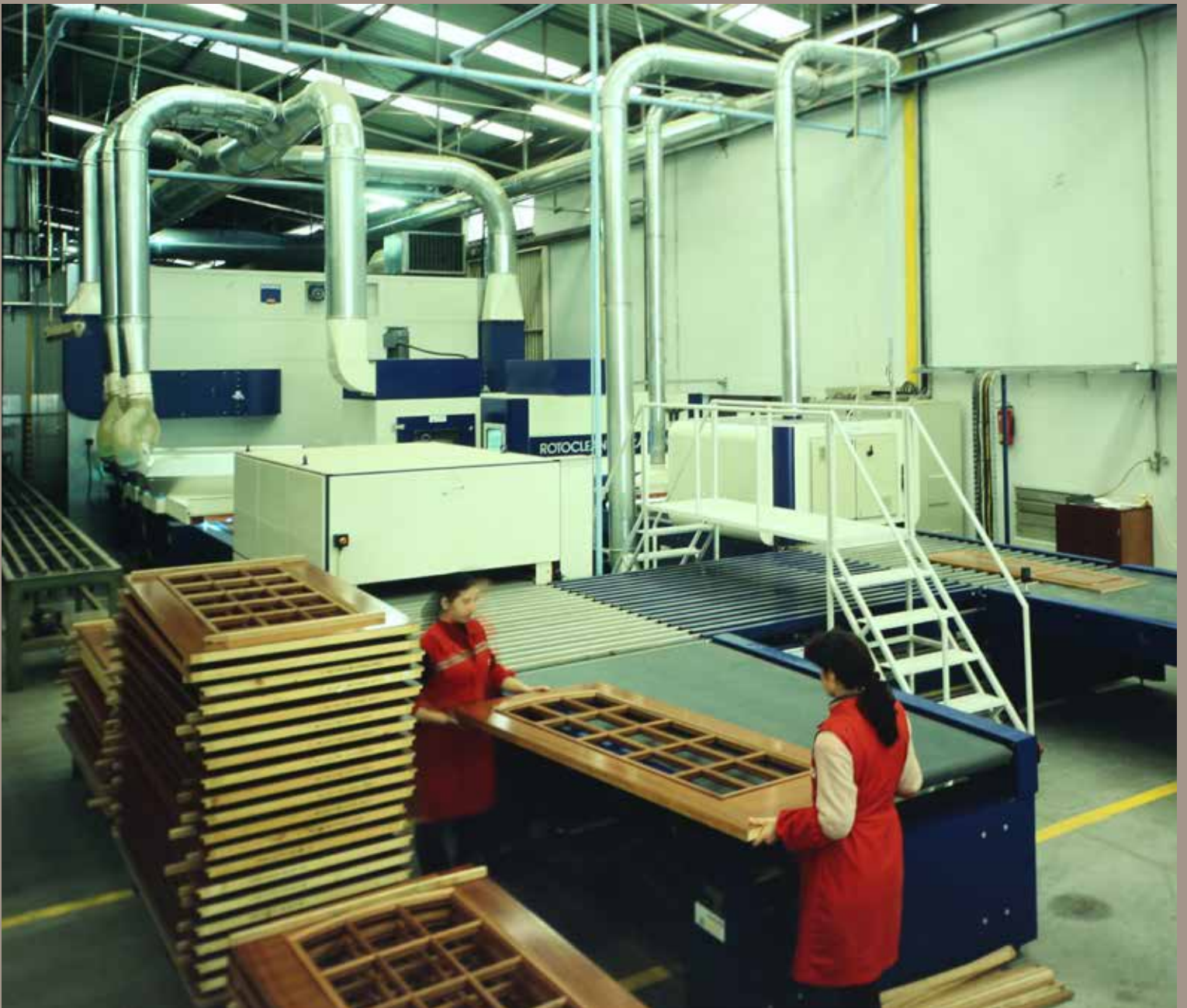
Linha de envernizamento da VICAIMA com processo de cura por raios ultravioleta (década de 1980)
