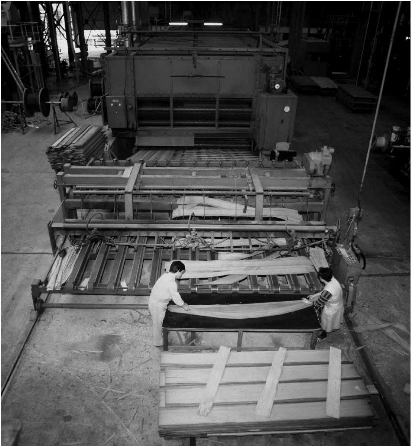
Secadores de folha de madeira para revestimento, também usado no fabrico de portas na VICAIMA (década de 1970)
